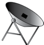
Cuiseur solaire à réflecteur parabolique
